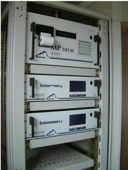
Equipamento de medição de partículas em suspensão ←
